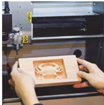
ミーリングマシンによる 3D データの実体化
